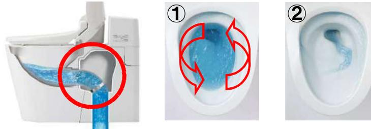
排水路が上を向き、①ボールに水をためた状態で水を長時間回転させ、②流れをコントロールして水を集め、勢いをつけて排水。
